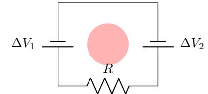
**Spiegazione** In questo circuito sono presenti due generatori ed un campo magnetico variabile interno che produce una forza elettromotrice indotta
