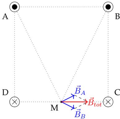
Il modulo del vettore  $\vec{B}_A$  lo calcolo con la legge di Biot-Savart
