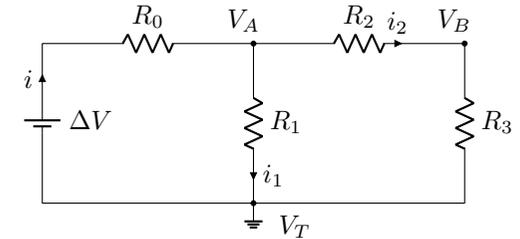
**Spiegazione** In questo circuito abbiamo solo un generatore di tensione continua ed una serie di resistenze. Le uniche formule di cui abbiamo quindi bisogno sono la prima legge di Ohm e le formule per sommare le resistenze in serie ed in parallelo. In questi circuiti si parte sempre con il determinare la resistenza totale del circuito e la corrente in uscita dal generatore. Successivamente si deve ragionare per trovare i valori di potenziale in ogni punto e le correnti in tutti i vari rami.
