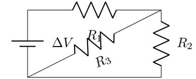
Quanto deve valere  $R_3$  affinché la resistenza  $R_2$  dissipi una potenza  $P = 1,6 W$ ?
