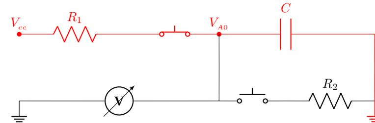
Nel processo di scarica abbiamo il seguente circuito
