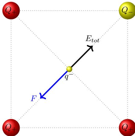
Fig. 3.3: Schema delle forze in gioco.
