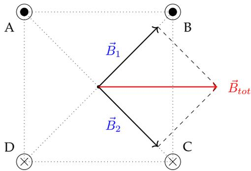
Fig. 4.2: Campo magnetico totale generato dai quattro fili percorsi da corrente.
