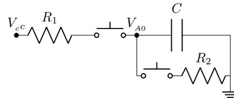
**Spiegazione** Circuiti RC. In questo problema è sufficiente sapere come si comporta un condensatore conoscendone la costante di tempo di carica e scarica e l'equazione temporale dei due fenomeni.
