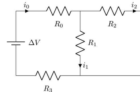
In questo circuito le resistenze  $R_1$  e  $R_2$  sono in parallelo, dando una resistenza equivalente  $R_{12}$  che a sua volta è in serie con  $R_0$  e  $R_3$ .
