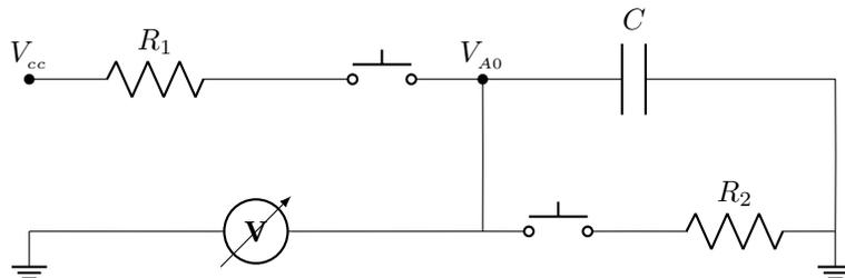
Come potete vedere uno degli estremi del condensatore è collegato alla terra, e quindi la differenza di potenziale agli estremi del condensatore coincide in questo caso con il valore del potenziale nel punto A0.
